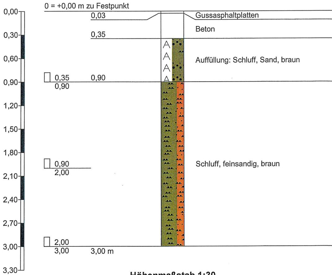
**Zeichnerische Darstellung von Bohrprofilen**
