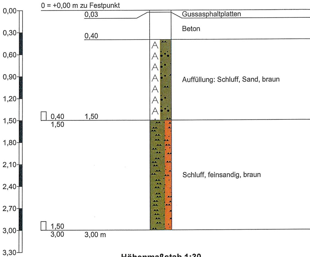
**Zeichnerische Darstellung von Bohrprofilen**
