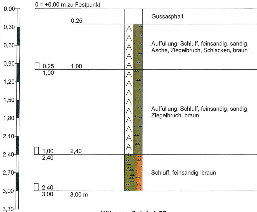
**Zeichnerische Darstellung von Bohrprofilen**
