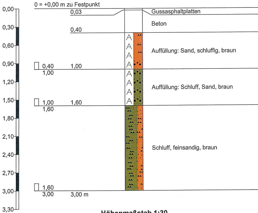
**Zeichnerische Darstellung von Bohrprofilen**
