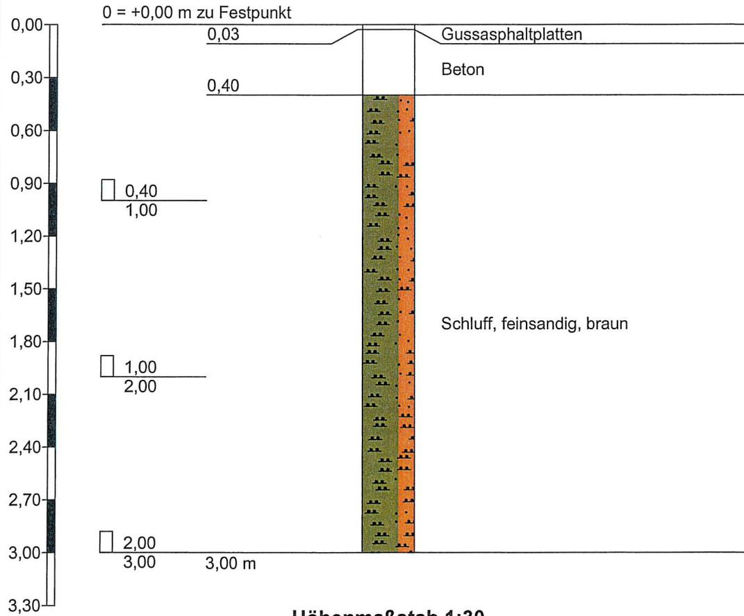
**Zeichnerische Darstellung von Bohrprofilen**
