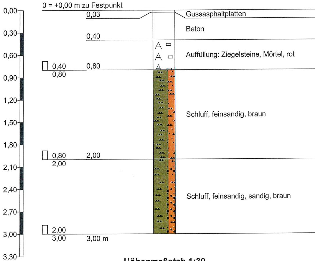
**Zeichnerische Darstellung von Bohrprofilen**
