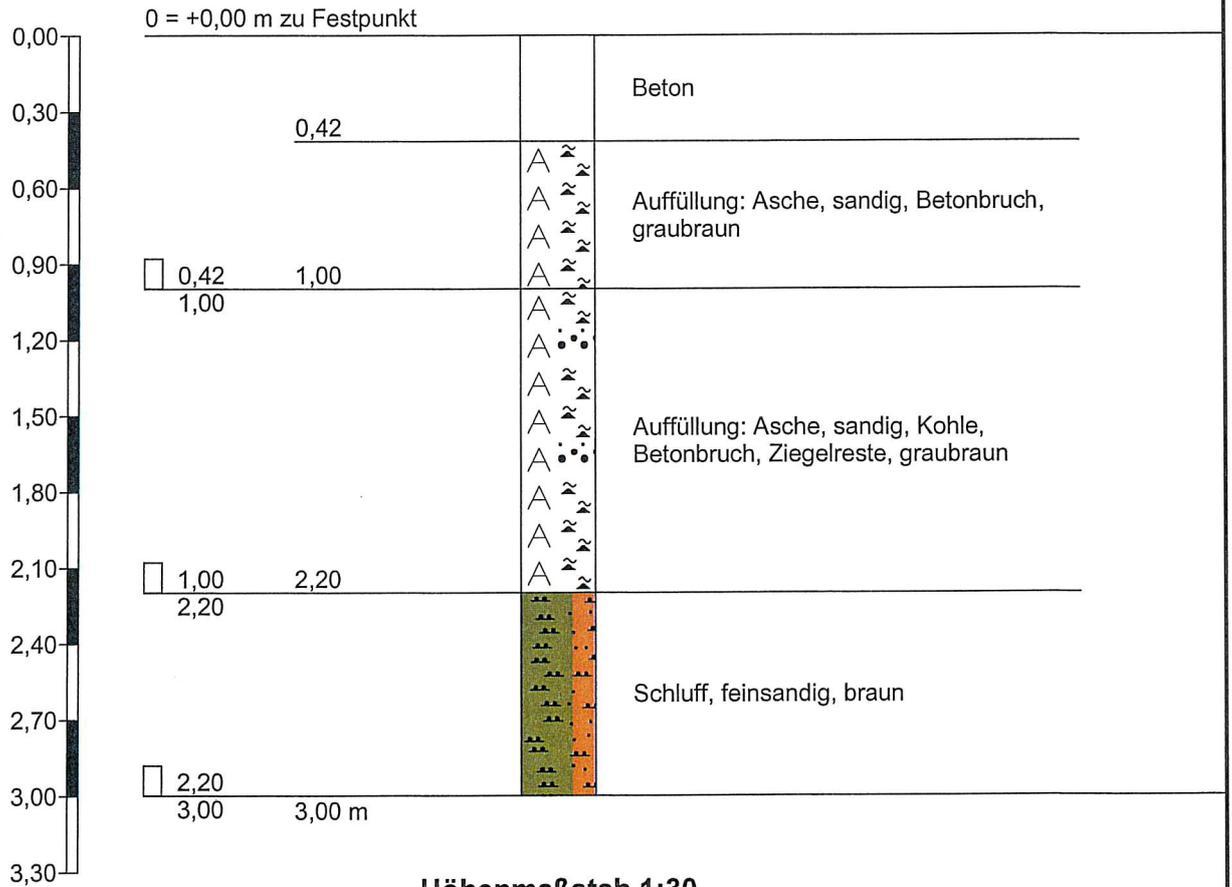
**Zeichnerische Darstellung von Bohrprofilen**
