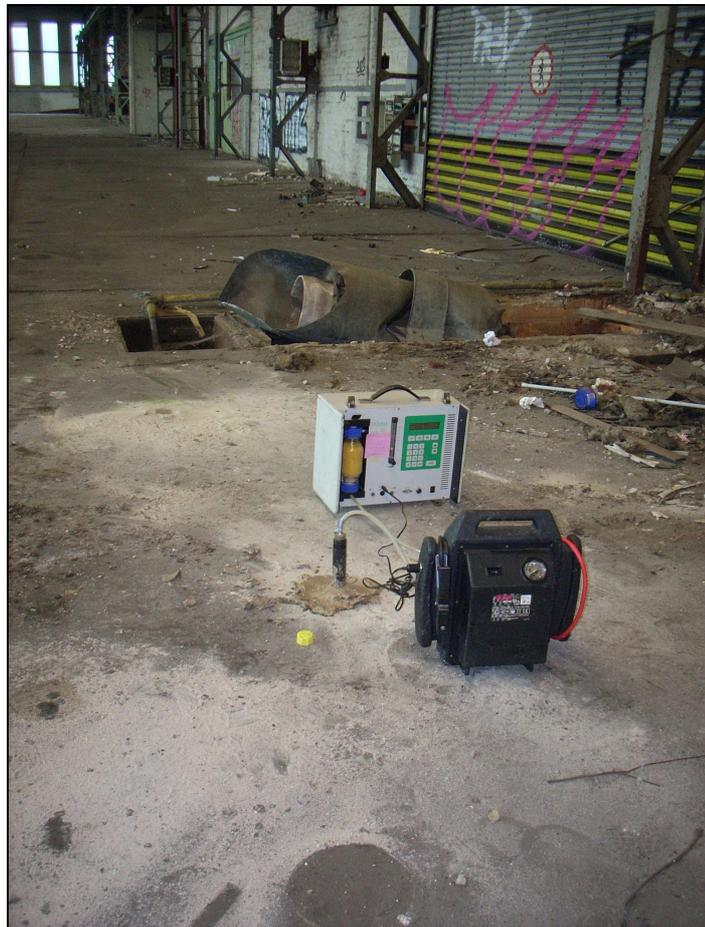
Foto 18: A-Shop: Bodenluftprobenahme im Bereich der ehemaligen Härterei (17.03.2010)
