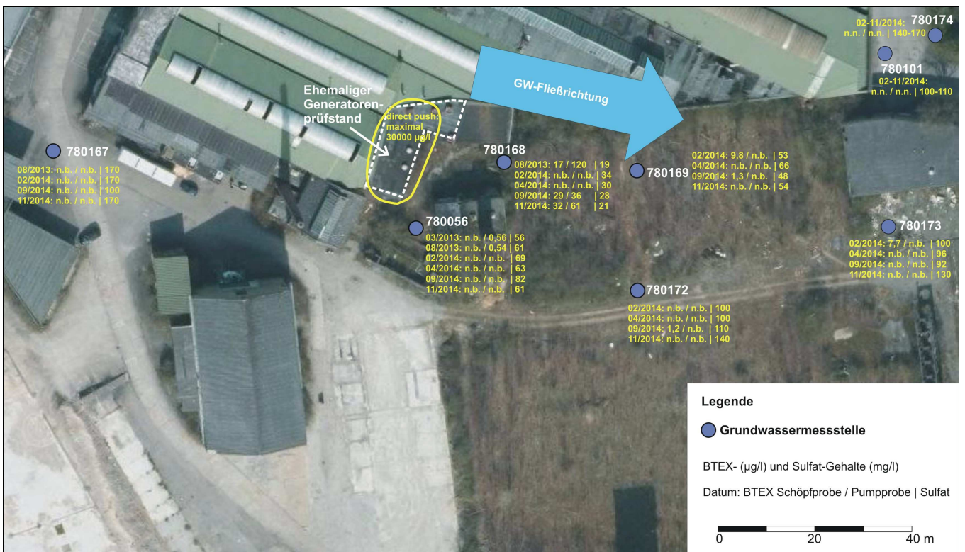
Abb. C 1-2: BTEX- und Sulfatkonzentrationen im Grundwasser der Messtellen im Umfeld des Generatorenprüfstandes
