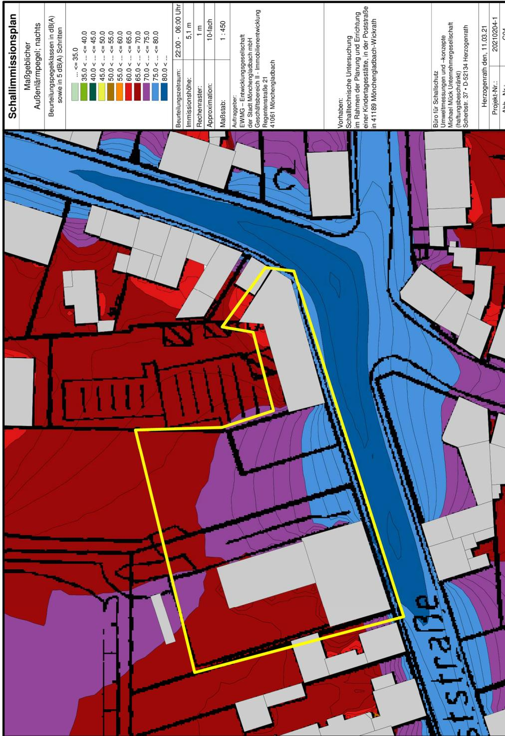
Abbildung 12-3 maßgeblicher Außenlärmpegel - Zuordnung auf die Größe „Lärmpegelbereich“
